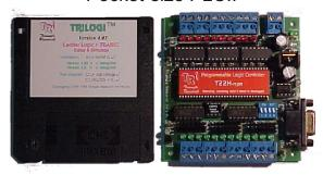
**T22H-npn** - 12 Inputs (12-24V DC) - 10 Outputs (1A @12-24VDC)
