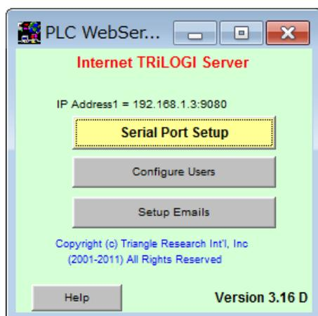
PLC WebServer のダイアログ画面の[Serial Port Setup]ボタンをクリックすると下記の様な Serial Communication Setup & Test 画面が表示します。
